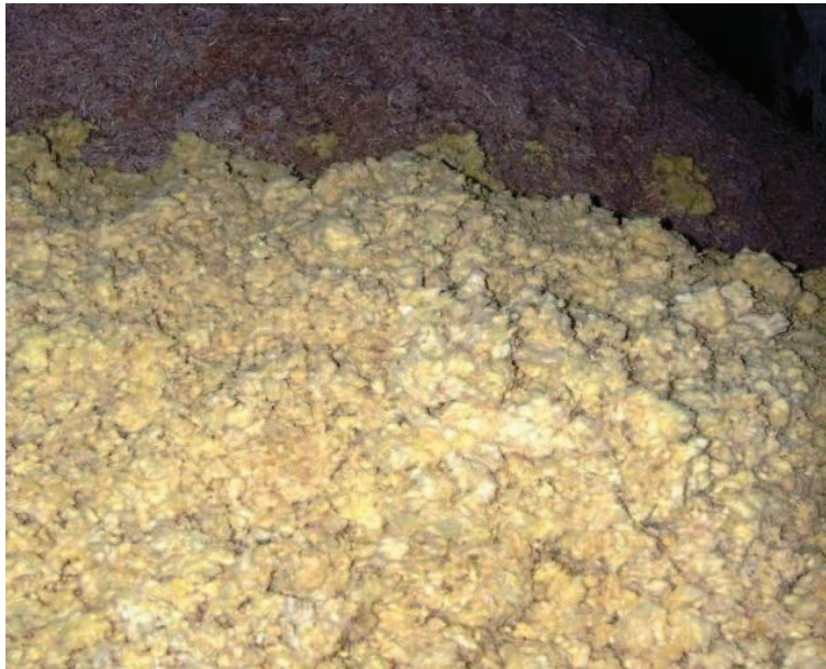
Obrázek 3.: Dávka vláken z kamenné vlny v míchačce na provozní lince
