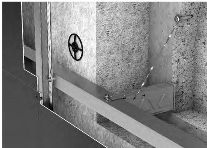
La staffa universale permette il montaggio con punti fissi e mobili.
