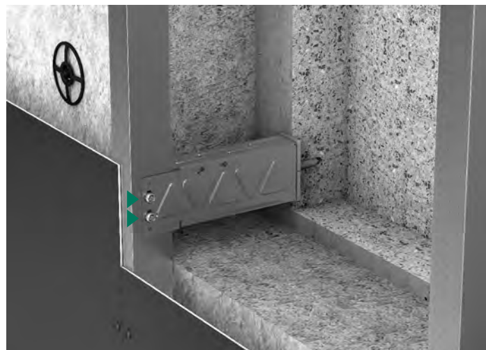
Punto mobile: Fissaggio in corrispondenza dei fori asolati.
