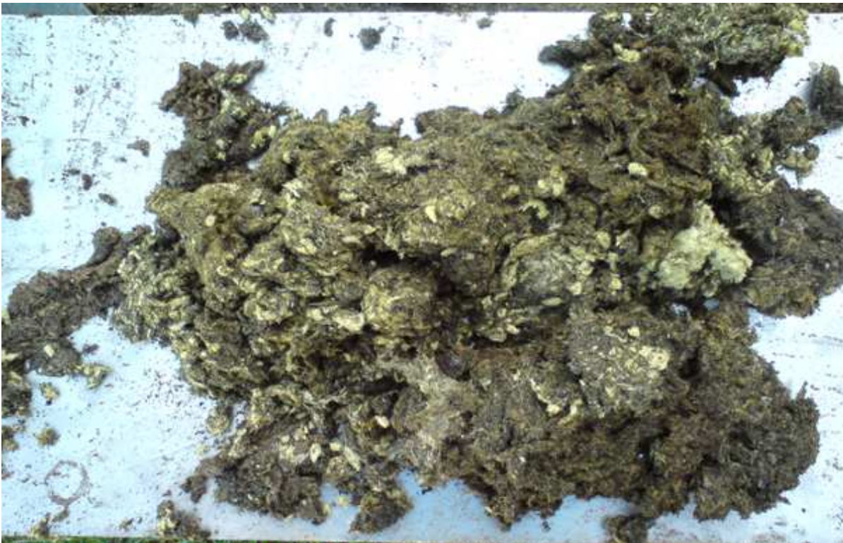
Maximálním přiblížením byl získán snímek struktury vlhké vaty s minerálním pískem. Obr.3
